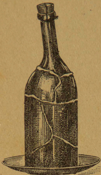
Fig. 304. — El agua al solidificarse se dilata.
