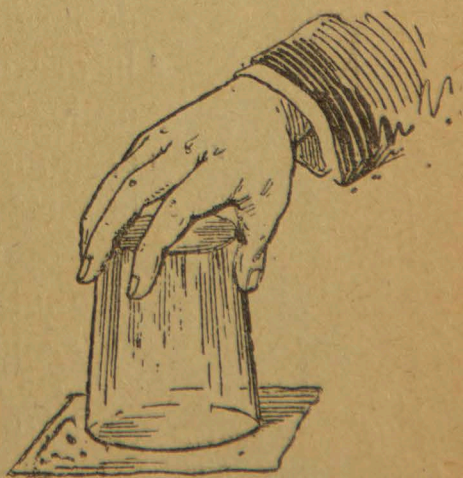
Fig. 237. — La presión atmosférica impide que caiga el agua.
