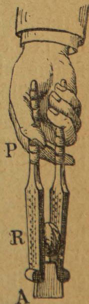
Fig. 215. — Palancas de 2 o género : carretilla, cascanueces.
