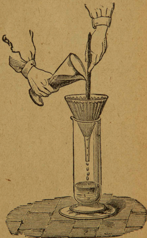
Fig. 319 -- Descoloración por el carbón animal.
