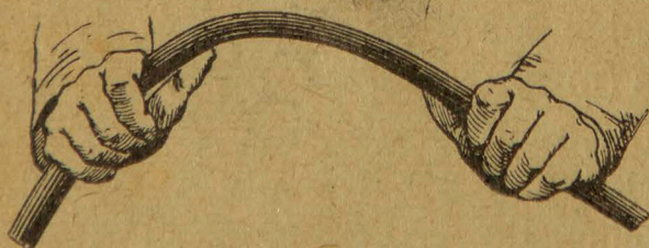
Fig. 206. — El plomo es flexible pero no elástico.
