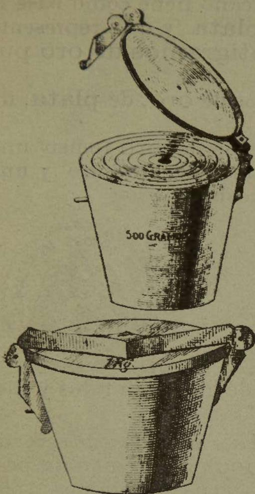
Estas pesas tienen la forma cilíndrica de altura igual al diámetro y provistas de botón para su fácil manejo. Pueden construirse de hierro fundido, de hierro dulce, de cobre, de latón, de bronce y de otros metales ó ligas de dureza inferior á la del acero, pero no á la del cobre.
