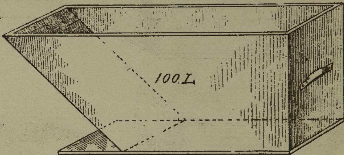
Todas estas medidas se construyen con madera, teniendo las cuatro primeras la forma de un prisma recto de base rectangular, truncado por un plano que pasando por una de las aristas menores de su base superior forme con la misma un ángulo de 135 grados. Las cinco medidas restantes tienen la forma de un prisma recto de base rectangular.
