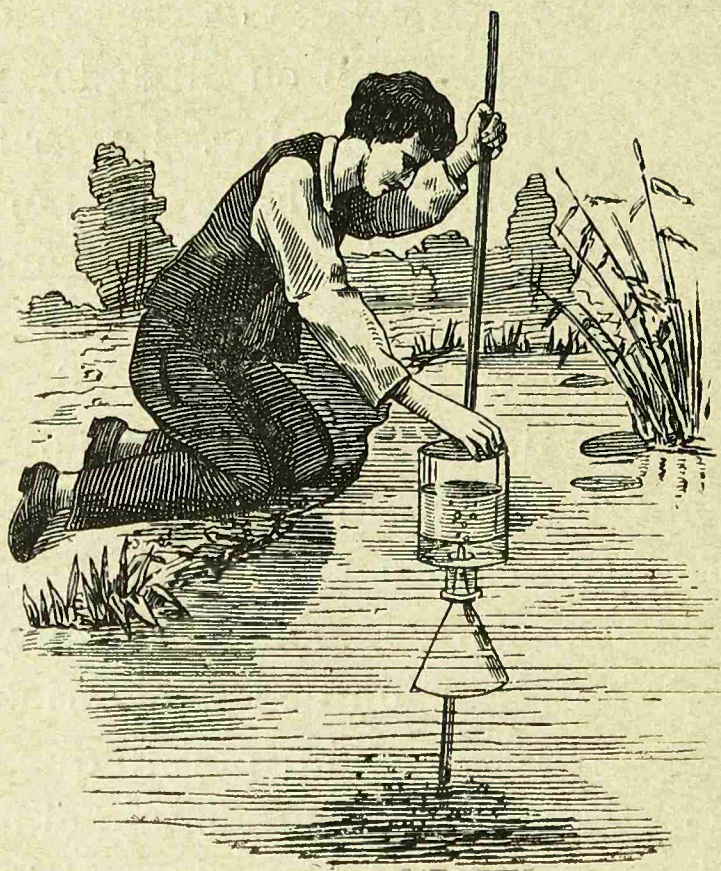
Manera sencilla de obtener el gas de los pantanos.
