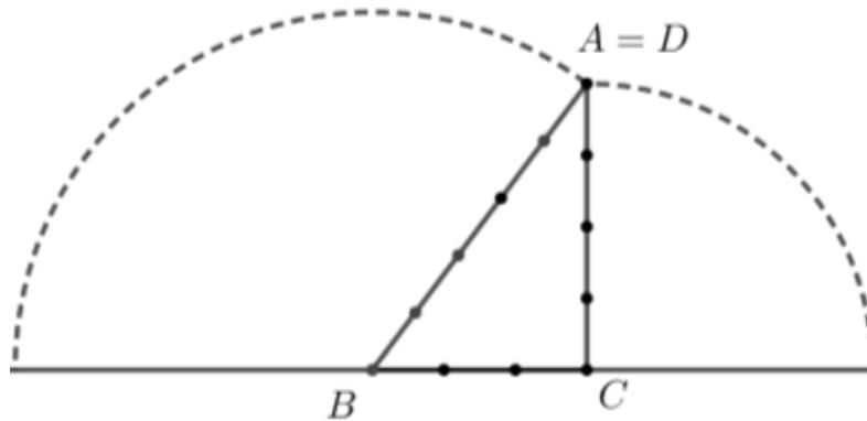
Figura 2.2. Construcción de un ángulo recto mediante una cuerda de 13 nudos igualmente
