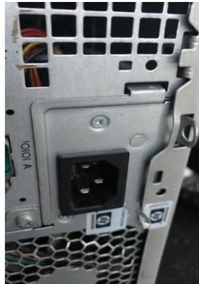
Identificamos en el CPU la entrada de alimentación y colocamos el cable de corriente.
