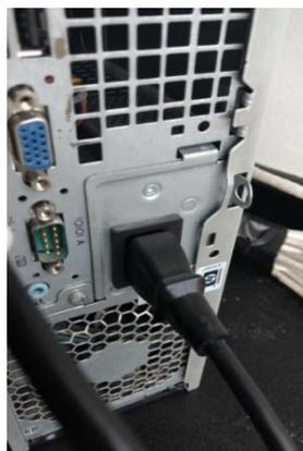
En esta posición debe quedar colocado el cable de alimentación.
