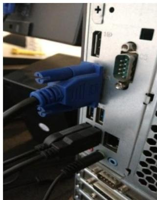
Hasta aquí llevamos conectados el teclado, ratón, plug de sonido (bocinas) y cable VGA del monitor.
