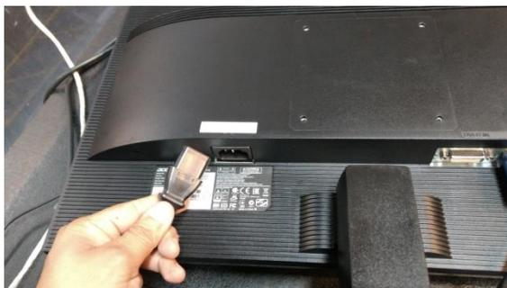
De la misma manera, se coloca el cable de alimentación en la entrada del monitor, como se muestra en la imagen.
