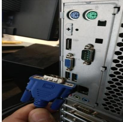
Se toma uno de los extremos del cable VGA y se conecta en la salida de color azul, como lo muestra la imagen.
