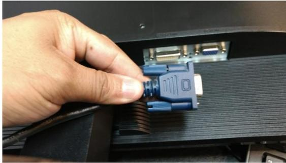
Ubicamos en la parte trasera de nuestro monitor la entrada VGA y conectamos el otro extremo del cable azul o cable VGA.
