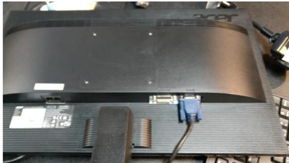
En la imagen se muestra la forma como debe quedar colocado el cable VGA en el monitor.
