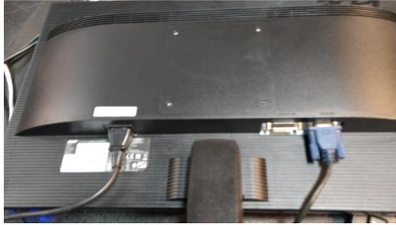
De esta forma quedan colocados el cable de alimentación y el cable VGA en el monitor.
