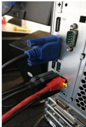
Para saber si tenemos conexión, debemos conectar el cable de Internet al CPU, inmediatamente después, debe parpadear con una luz, como se muestra en en el paso 7.
