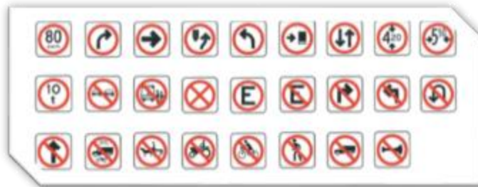
Señalamientos de restricción
