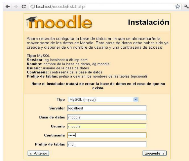
Figura 11. Configuración de la base de datos.
