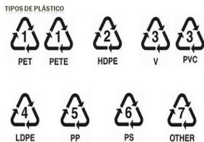
Fig.5.9. Clasificación de los tipos de plásticos.
