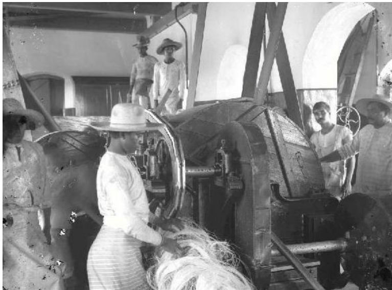
Máquina desfibradora de henequén 1916.
